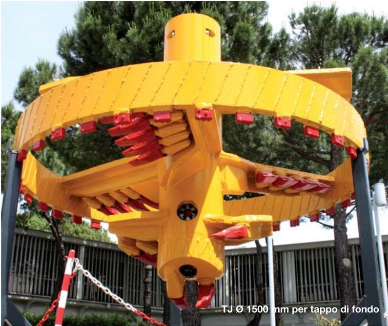
La tecnologia Turbojet consente di realizzare colonne conpenetrate a geometria predefinita e controllata.
