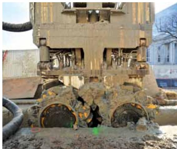
Particolare della testa fresante di un'idrofresa
